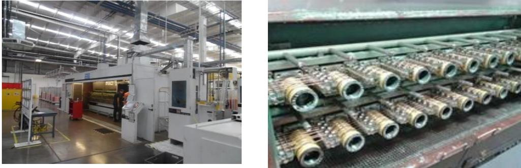
*Figura 5. Componentes de las maquinas trefiladoras.*
